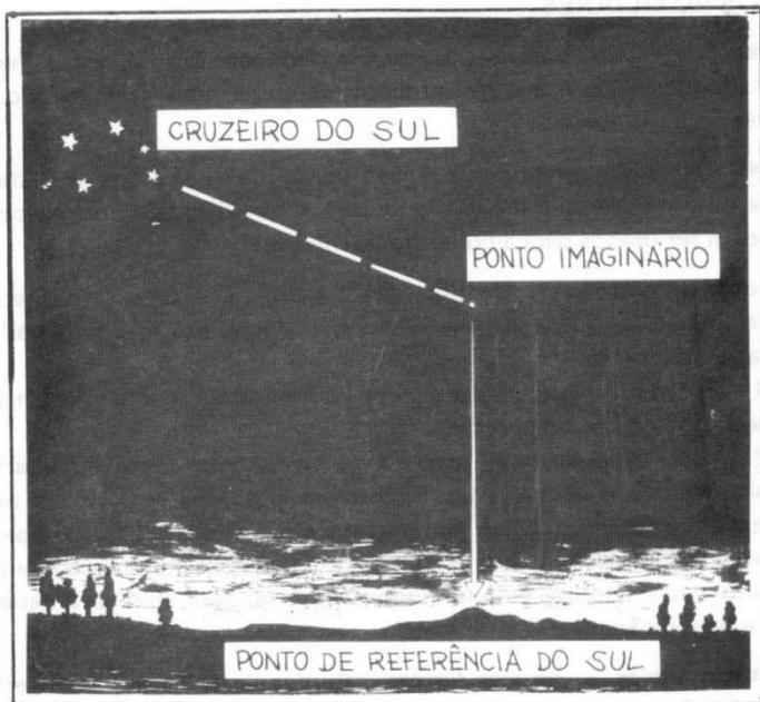
Fig 3-14. Determinação do Sul pelo Cruzeiro do Sul.
