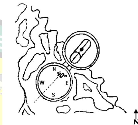
Azimute geográfico com bússola prismática
